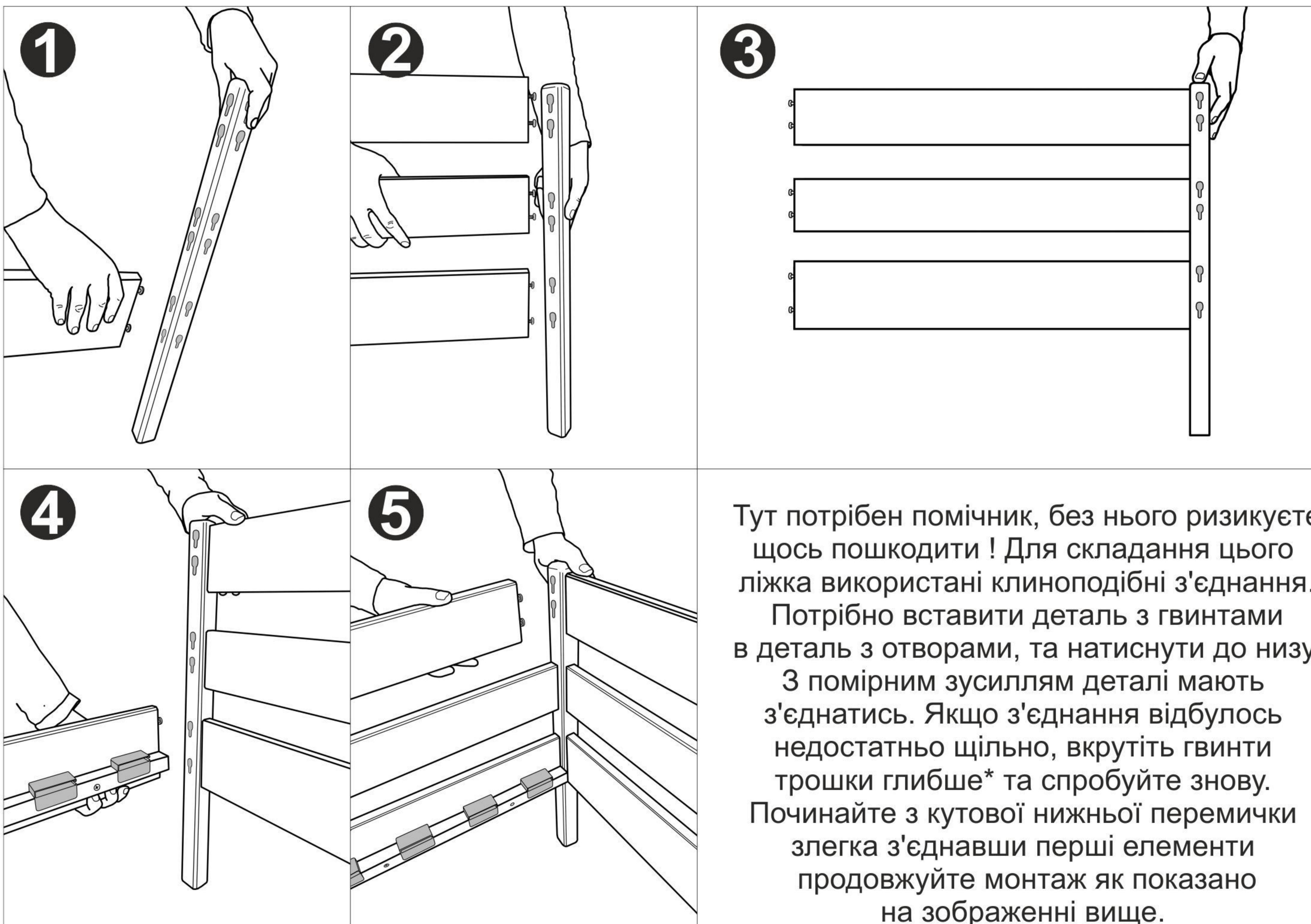
Тут потрібен помічник, без нього ризикуєте щось пошкодити ! Для складання цього ліжка використані клиноподібні з'єднання. Потрібно вставити деталь з гвинтами в деталь з отворами, та натиснути до низу. З помірним зусиллям деталі мають з'єднатись. Якщо з'єднання відбулось недостатньо щільно, вкрутіть гвинти трошки глибше\* та спробуйте знову. Починайте з кутової нижньої перемички злегка з'єднавши перші елементи продовжуйте монтаж як показано на зображенні вище.
